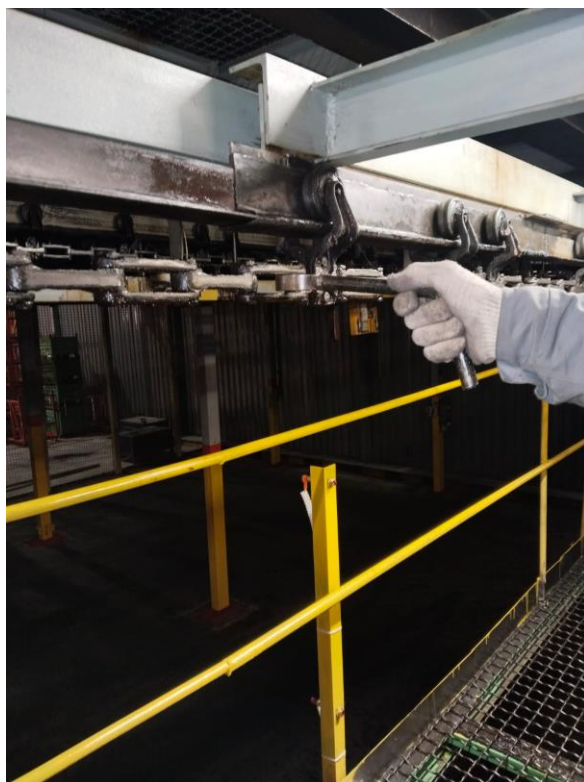
Рис. 2. Визуализация процесса шаблонирования цепи
